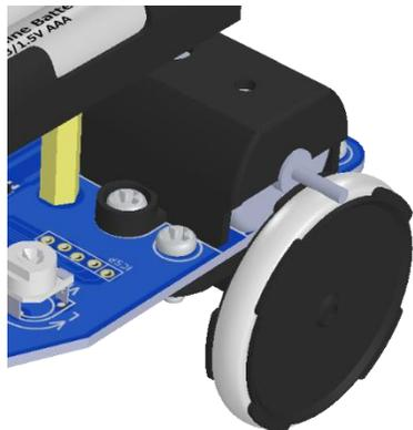
摩擦車を使って、「**速度伝達比**」(回転運動の速さ、力)を変えています。
