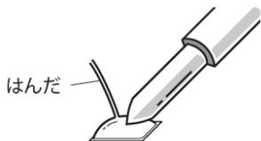
③ はんだをつけた端子の上にコードを重ねて、コードを抑えるようにして温めて固定します。
